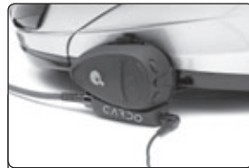
collegare il cavo MP3 all'attacco dell'auricolare del Morsetto sul casco
