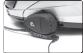
das Audiokabel in die Buchse der Klemmhalterung geben
